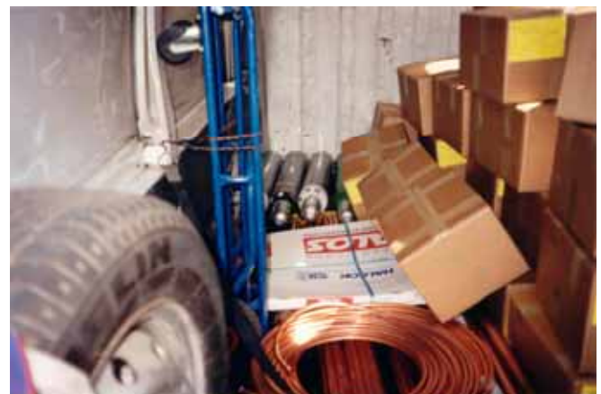
Abb. 5: Ladungssicherung beginnt im Betrieb – das gilt auch für den Monteur, der in seinem Kombi Gasflaschen befördert.
