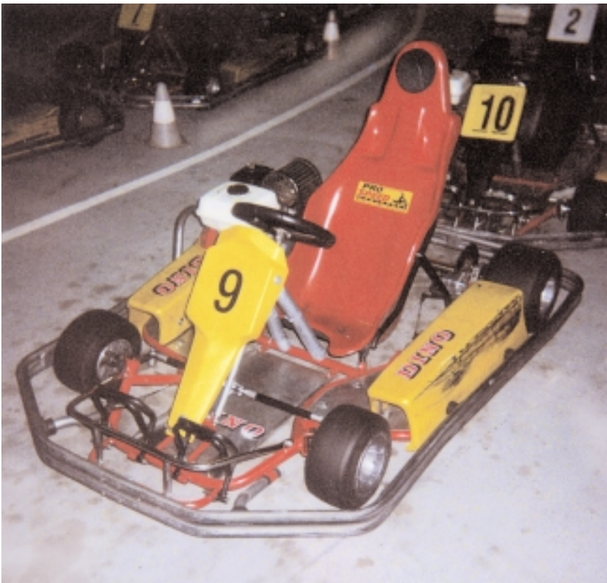
Abb. 1: Positiv: Fahrersitz mit hochgezogener Rückenlehne und integrierter Kopfstütze, durchlaufender Rundum-Rammschutz. Es fehlen die Sicherung der Bodenöffnungen sowie Sicherheitsgurt und Überrollbügel
