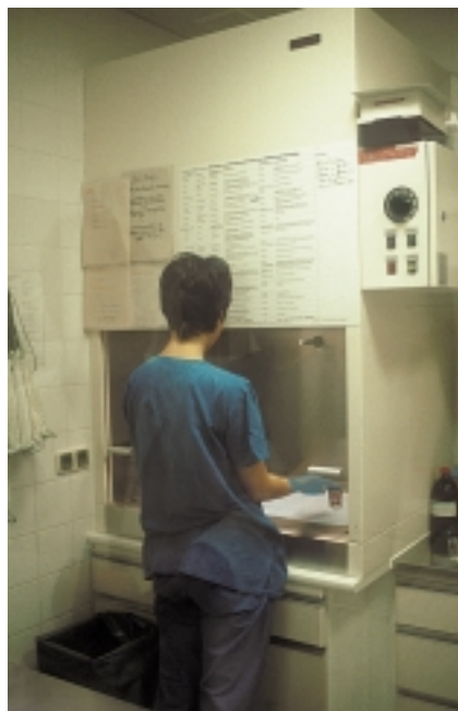
Abbildung 2: Inzwischen aufgegebene „Zytostatika-Zubereitung“ in einem zu kleinen „Multifunktionsraum“ an ungeeigneter mikrobiologischer Sicherheitswerkbank. Die persönliche Schutzausrüstung der Krankenschwester ist unzureichend.
