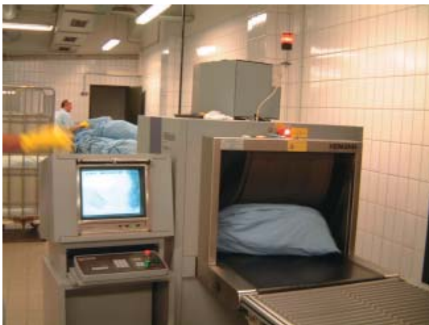
Abb. 3: Durchleuchtungsgerät zur Überprüfung der Wäsche auf Störstoffe
