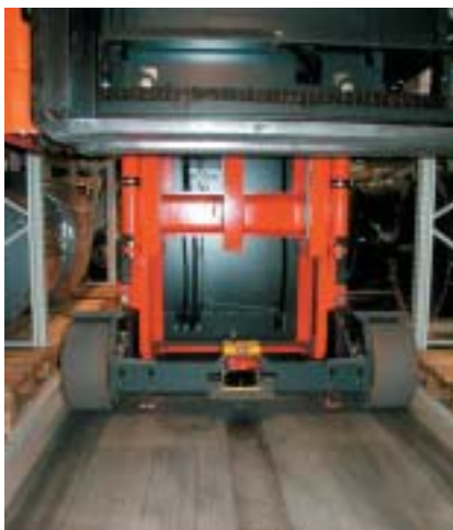
Flurförderzeug mit Laserscanner zur ständigen Fahrbereichsüberwachung
