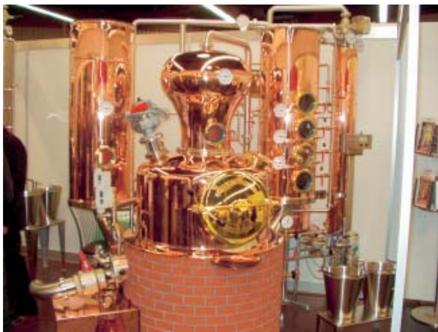
Abb. 1: Branntwein-Destille als Druckgerät
