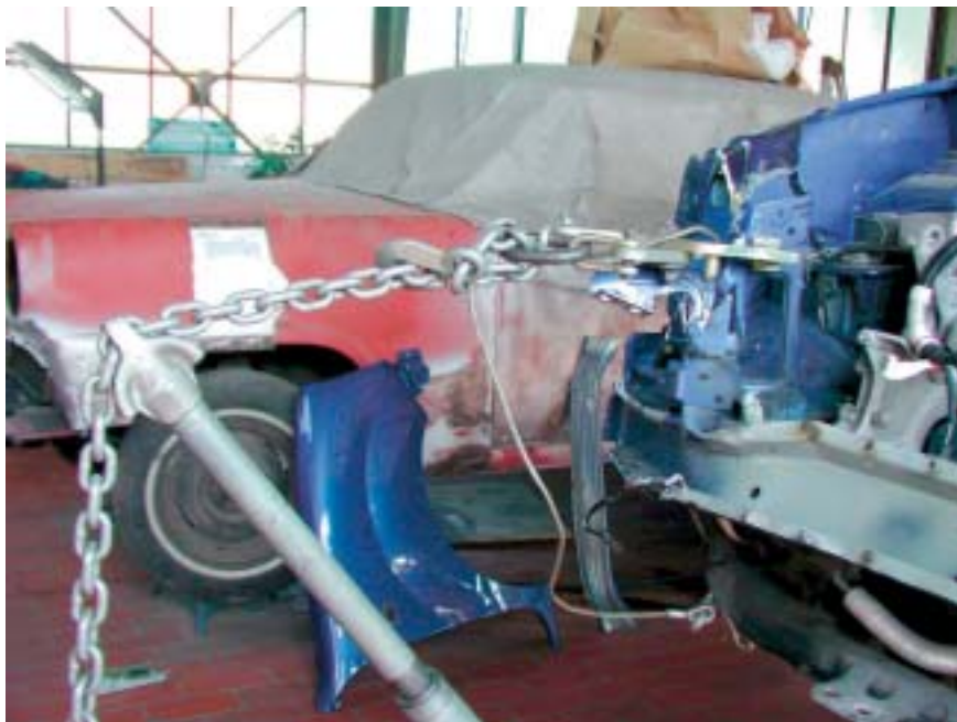
Abb. 2: Befestigung einer gesicherten Zugklemme an der Karosserie
