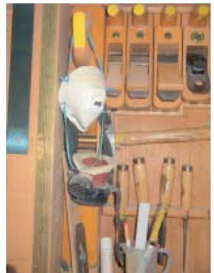
Abb. 1 und 2: Ungeeignete Aufbewahrung der Atemschutzmaske
