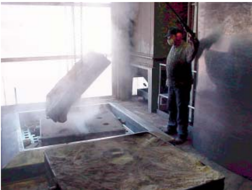
Abb. 2: Entnahme eines Gusses aus dem Rüttelrost
