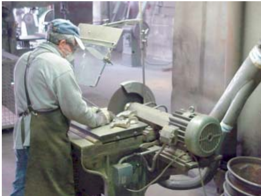
Abb. 1: Gussputzen unter Verwendung persönlicher Schutzausrüstung
