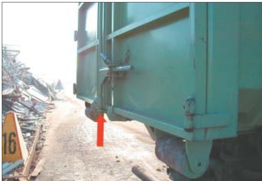
Bild 3: Zentralverriegelung eines Abrollbehälters
