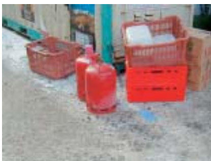
Abb. 1: Vorschriftswidriges Abstellen von Flüssiggasflaschen
