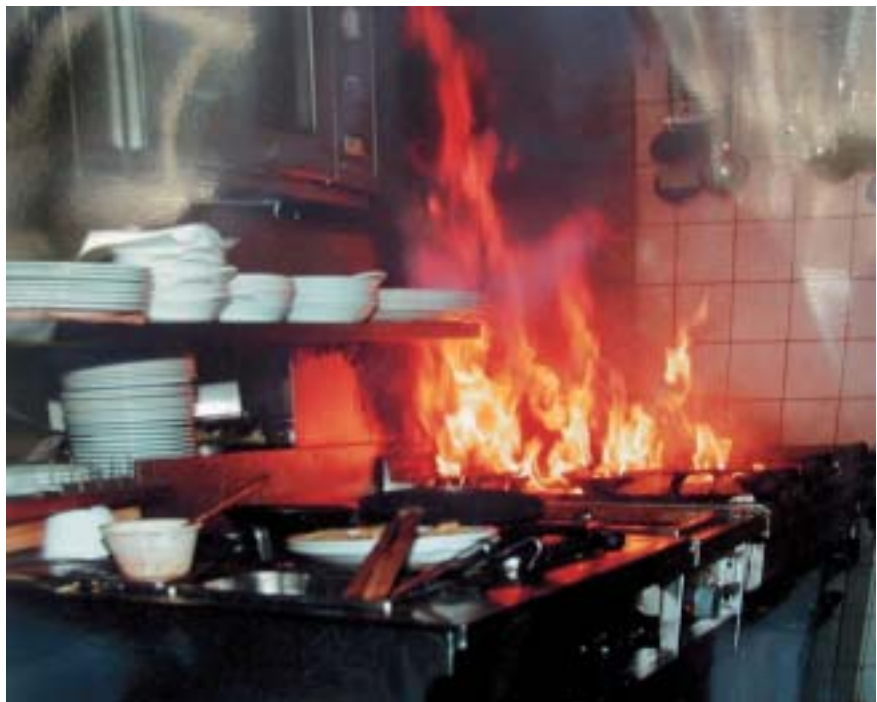
Abb. 1: Brandcontainer mit brennender Friteuse nach Löscheversuch mit Wasser (Foto Berufsfeuerwehr München)
