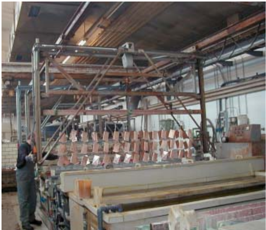
Abbildung 1: Bedienen einer halbautomatischen Beschickungsanlage
