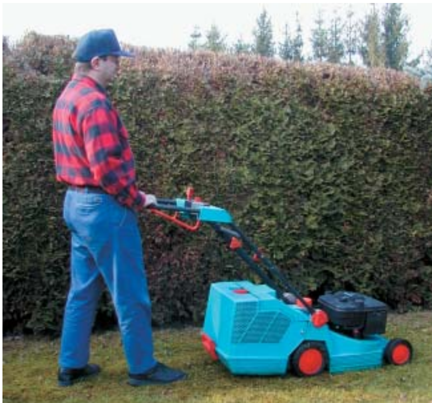
Abb. 1: Für einen Rasenmäher mit einer Schnittbreite von bis zu 50 cm gilt ein zulässiger Schallleistungspegel von 96 dB.
