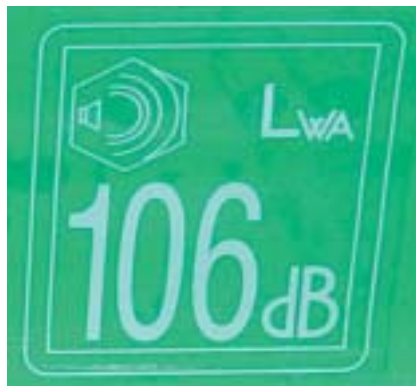
Abb. 3: Tafel mit Angabe des garantierten Schalleistungspegels in dB, dem Zeichen „LWA“ und einem Piktogramm
