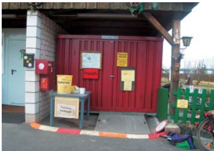
Sammelstelle mit Zwischenlager auf einem Wertstoffhof (Annahme- und Arbeitsbereich sowie Lagergestaltung sind mangelhaft)
