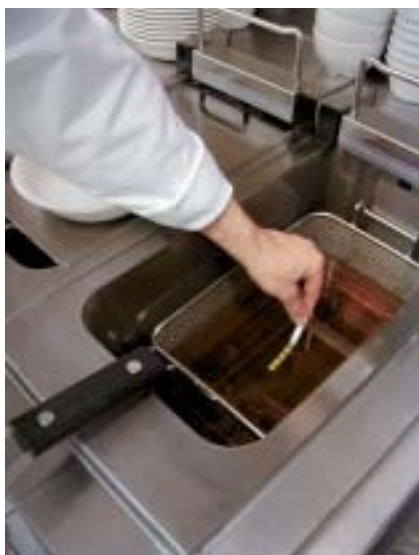
Abb. 2: Kontrolle der Fettqualität mittels Teststreifen
