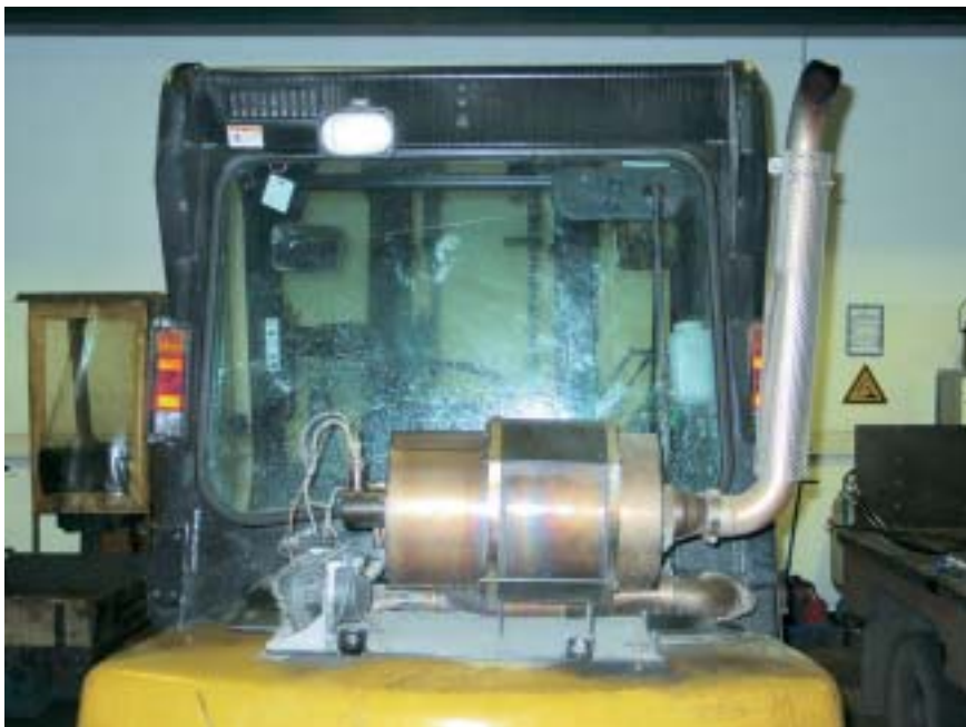
Stapler mit Dieselpartikelfilter (ohne Schutzabdeckung)
