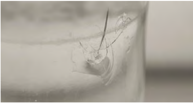
Abbildung 6: Diese zersplitterte Flasche verursachte einen Fremdkörpereintrag.
